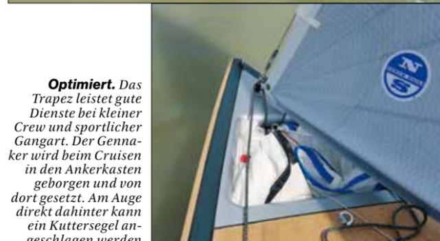
**Optimiert.** Das Trapez leistet gute Dienste bei kleiner Crew und sportlicher Gangart. Der Gennaker wird beim Cruisen in den Ankerkasten geborgen und von dort gesetzt. Am Auge direkt dahinter kann ein Kuttersegel angeschlagen werden
