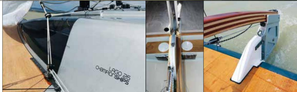
Die Idee dahinter: Segelt der Eigner ohne Großschottrimmer, bedient er die Schot über den achteren Block, hat er einen Trimmer zur Seite, fährt dieser die Schot über den vorderen Ratschblock. Die Schot ist durchlaufend, beim Wechsel sollte man daher darauf achten, dass immer genügend Leine zum Fieren vorhanden ist. Gut erreichbar ist auch die Achterstag-Trimmeleine, die verdeckt im Cockpitboden vor die Großschotblöcke geführt wird und sich dort gut bedienen lässt.
